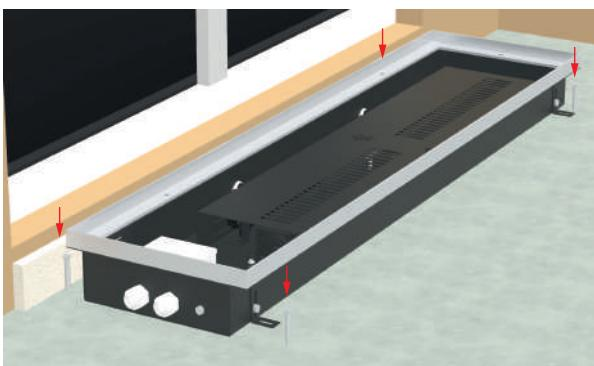
3. С помощью юстировочных винтов выровнять корпус конвектора в горизонтальной плоскости с допуском  $\pm 1$  мм. При выравнивании конвектора необходимо учитывать, чтобы верхняя кромка декоративной рамки (или окантовки), находилась заподлицо с напольным покрытием;
