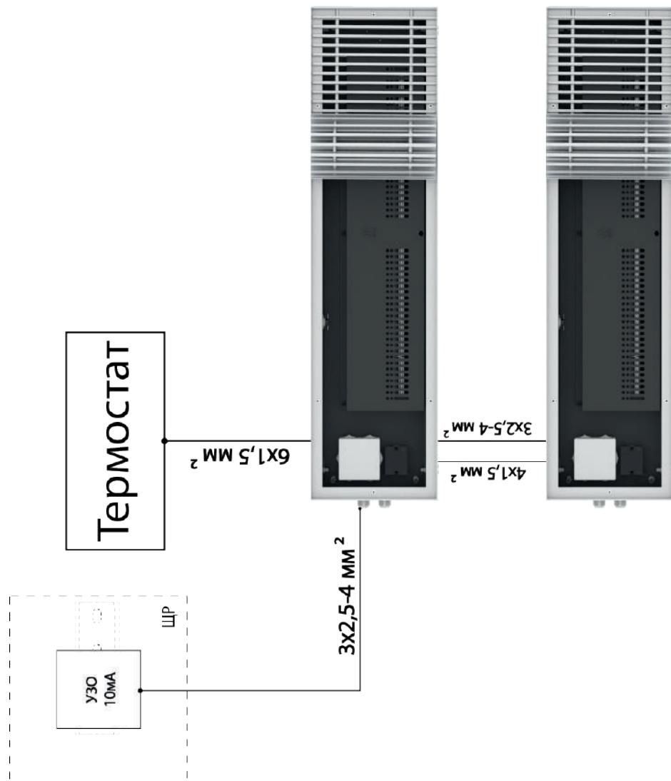
Для защиты от поражения электрическим током необходимо установить устройство защитного отключения (УЗО) с номинальным отключающим дифференциальным током, не превышающим 10 мА.
