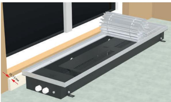
Размеры отопительного канала должны иметь припуск по высоте (H) +10...15 мм, по длине (L) +100...300 мм и ширине (B) +150 мм по отношению к габаритным размерам конвектора.
