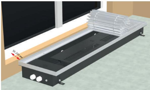
Рекомендуется применять теплоизоляцию отопительного канала между корпусом конвектора и наружной стеной (материал: плита из полистирола толщиной 10-15 мм);
